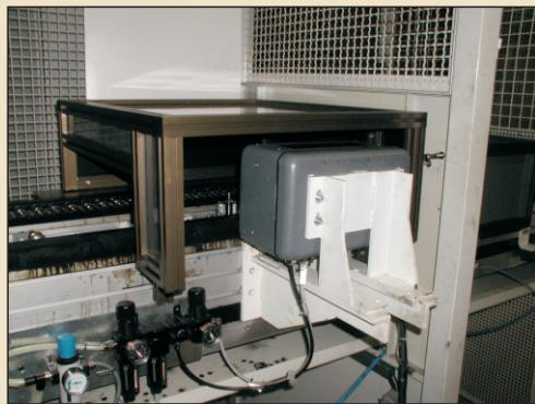
Для позиционирования маркирующей иглы системы напротив каждого вала была использована камера, смонтированная на картридже головке. Камера используется для нахождения центра торца каждого вала. Как только центр найден, маркирующая игла располагается соответствующим образом запускает начало цикла маркировки.
