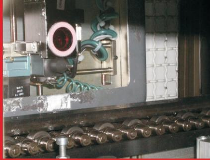
Для решения вопроса автоматизированного считывания маркировки было решено к буквенноцифровому тексту добавить двумерный код DataMatrix, включающим 16 символов. Даже при низкой контрастности этот код можно использовать для отслеживания всех валов в рамках всего производственного процесса с требуемой степенью надёжности. Также благодаря своей форме размер DataMatrix составляет всего 3 x 3 мм.
