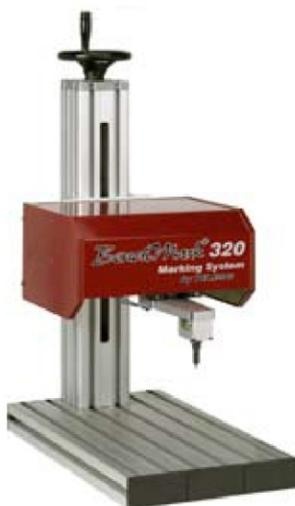
Система **BenchMark® 320** – это недорогой полностью программируемый и мобильный маркировочный станок. Благодаря электромеханическому приводу иглы подвод воздуха не требуется, что позволяет легко перемещать систему BenchMark® 320 с одного рабочего места на другое. Окно маркировки составляет 100 x 150мм. Скорость маркировки – до 5 символов в секунду.
